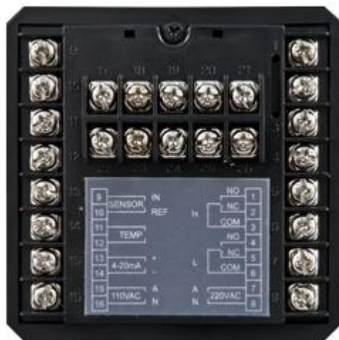
Aquí ve las conexiones del regulador de pH
