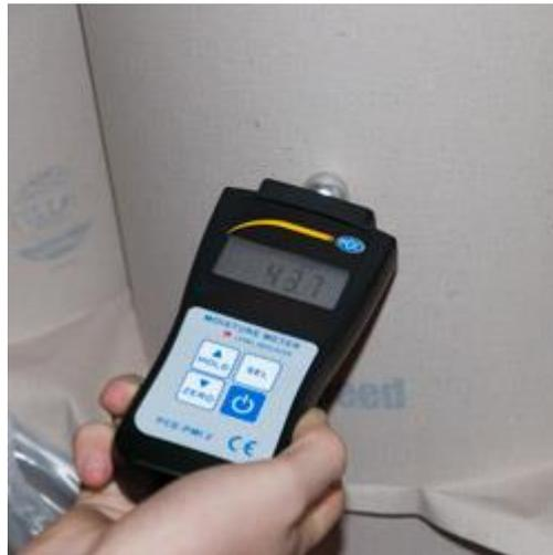
El PCE-PMI 2 es un equipo ideal para cualquier obra. Con el indicador de humedad de material podrá detectar de forma inmediata si el suelo de cemento está ya seco, o si requiere algo de tiempo antes de poder trabajar sobre él.
