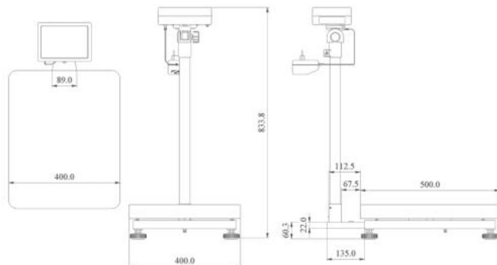
Aquí ve las dimensiones de la balanza de industrial verificable de la serie PCE-SD C
