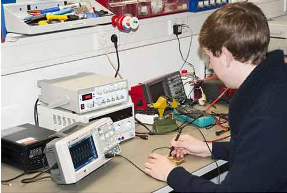
Aquí puede ver la aplicación del osciloscopio registrador de 2 canales en un análisis de errores de una placa defecta.
