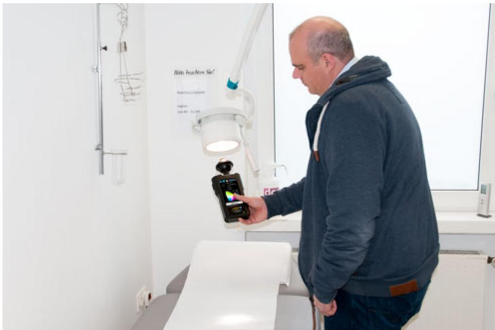
Espectrómetro comprobando una iluminación médica
