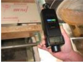
Medición por contacto de una línea de empaquetado con el tacómetro.
