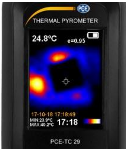
La pantalla de la cámara infrarroja de inspección muestra, además de la imagen, otras informaciones.
