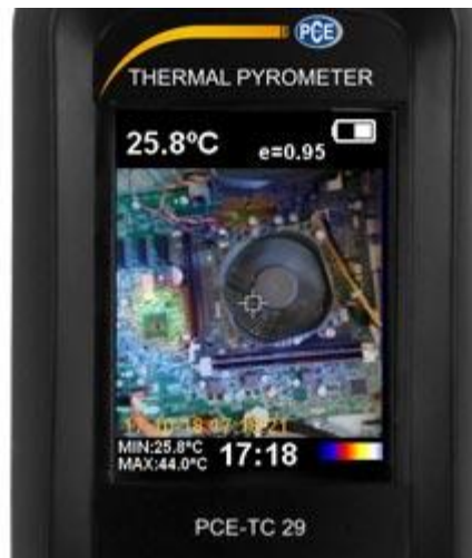
La función de imagen superpuesta de la cámara infrarroja de inspección se gradúa en pasos de 25 %.
