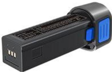
La cámara infrarroja cuenta con una potente acumulador como fuente de alimentación. El acumulador de 4200 mAh permite un uso continuo de hasta 4 horas. A parte del mecanismo de cierre normal, el acumulador dispone de un cierre de seguridad. Esto impide que el acumulador se suelte de la cámara, evitando interrupciones en la medición. Encontrará el cierre de seguridad en la parte inferior de la batería y podrá cerrarlo de forma sencilla con los dedos.
