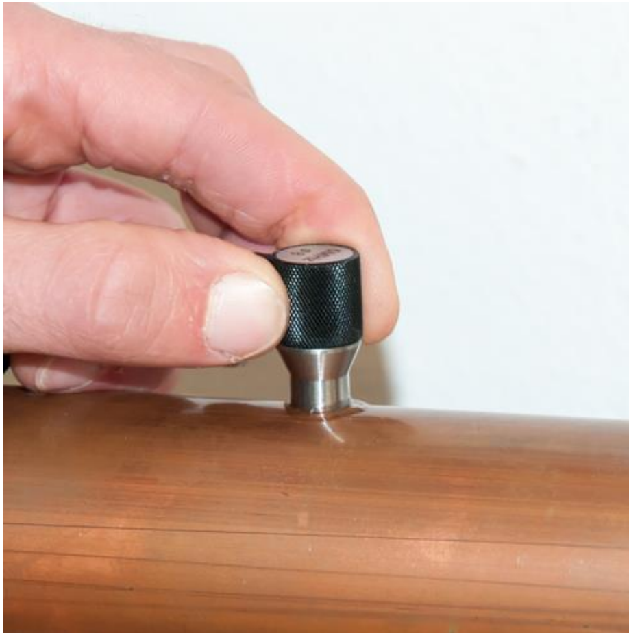
Cabezal del medidor de espesor de materiales PCE-TG 50 usando gel de acoplamiento sobre una tubería de cobre
