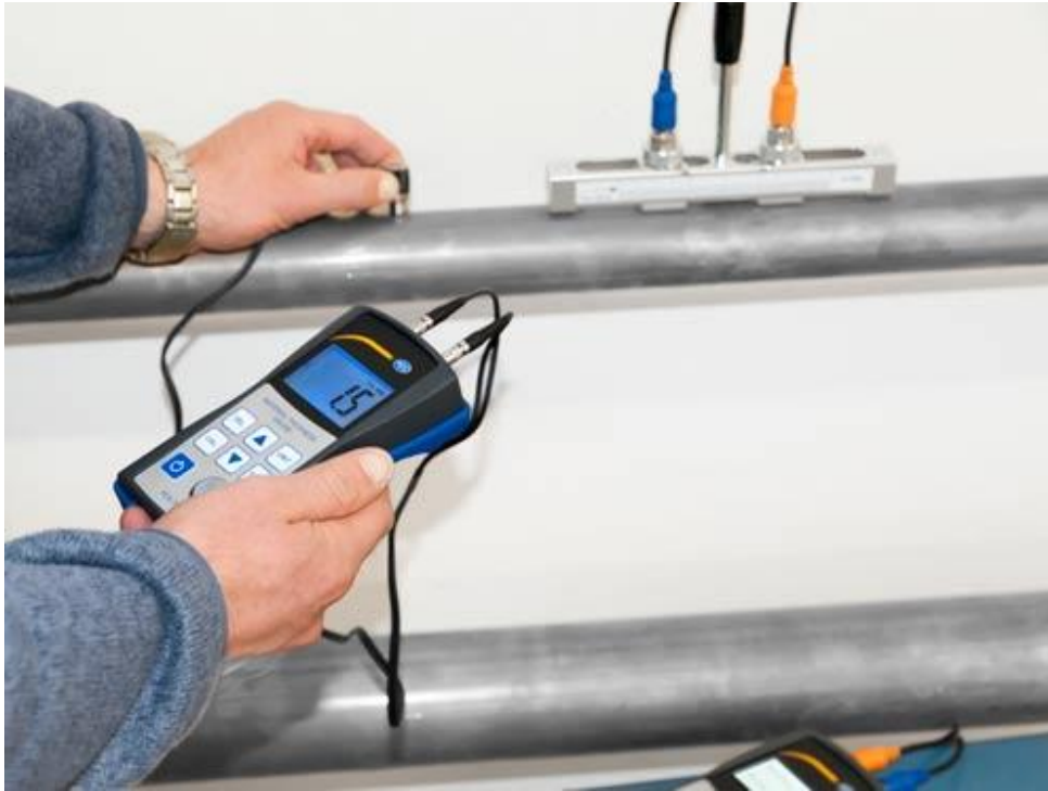
Aquí se aprecia el medidor de espesor de materiales PCE-TG 50 comprobando una tubería
