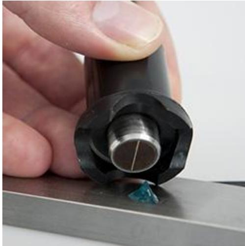
Medidor de espesores de material realizando una medición
