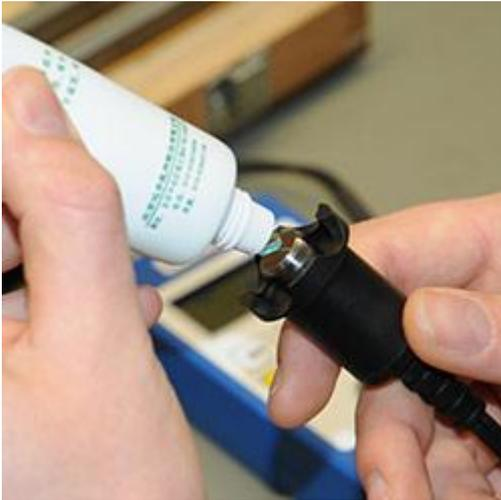
Medidor de espesores de material con gel de acoplamiento
