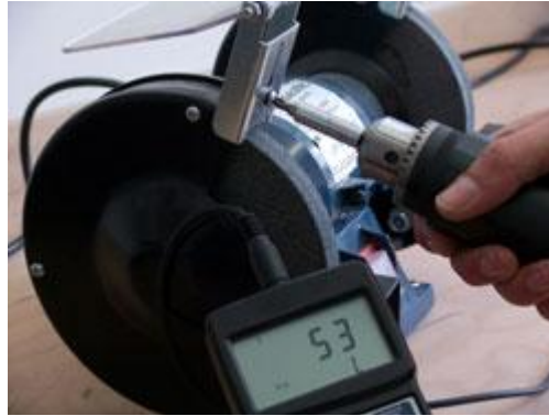
Los valores determinados se pueden leer directamente en pantalla del medidor de torque
