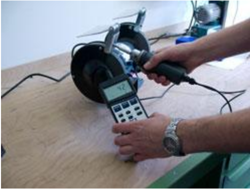
Medidor de torque midiendo el par de apriete en una amoladora.
