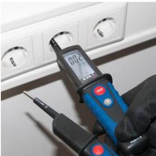
Control de fase (un polo) con el comprobador de tensión PCE-TT2
