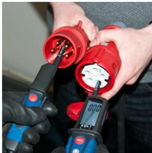
Uso del comprobador de tensión PCE-TT 2 como comprobador de continuidad en un
