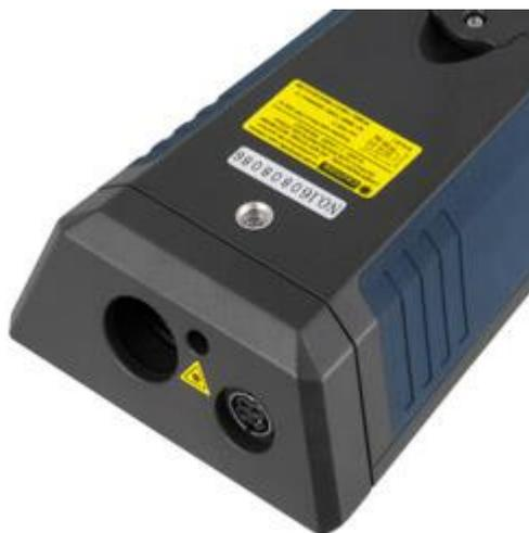
La rosca para montar el anemómetro PCE-VA 11 sobre un trípode se encuentra en la parte posterior.
