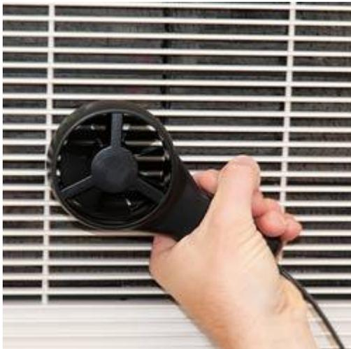
Aquí ve el anemómetro PCE-VA 10 midiendo en un sistema de ventilación.
