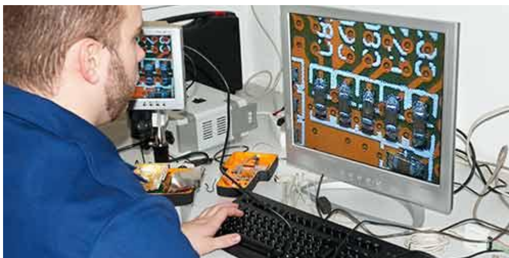
Gracias a la interfaz USB el microscopio para taller puede conectarse a un PC. Para ello se necesita un software especial (no contenido en el envío).
