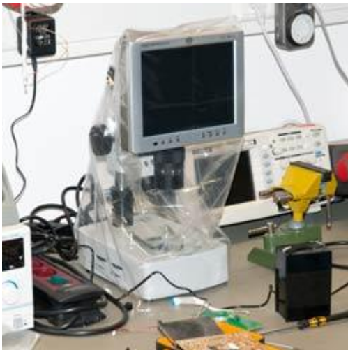
El microscopio para taller con la funda de protección contra polvo suministrada
