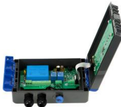
La caja abierta del controlador de alarma para sensores de velocidad de viento.
