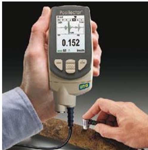
El espesímetro de materiales PT-UTGM realizando una medición en un tubo
