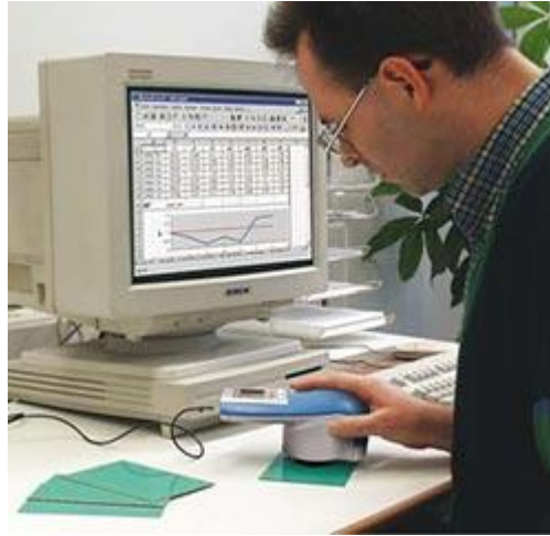
El medidor de color y brillo en la grabación de datos y transmisión a un PC.
