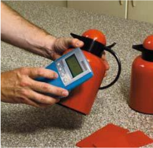
Aquí se ve el medidor de color y brillo en la medición de color y brillo de diferentes teteras.
