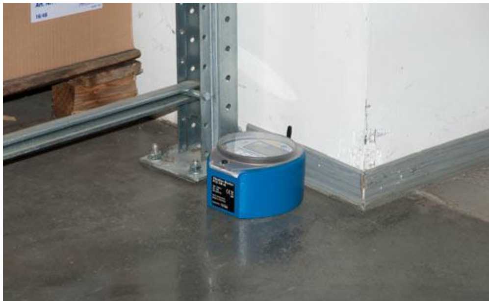
Medidor de vibraciones DIN 4150-3 para edificios y construcciones.
