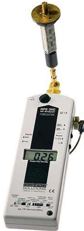
Set de detección de alta frecuencia HFE35C con antena casi isotrópica de banda ultra ancha conectada
