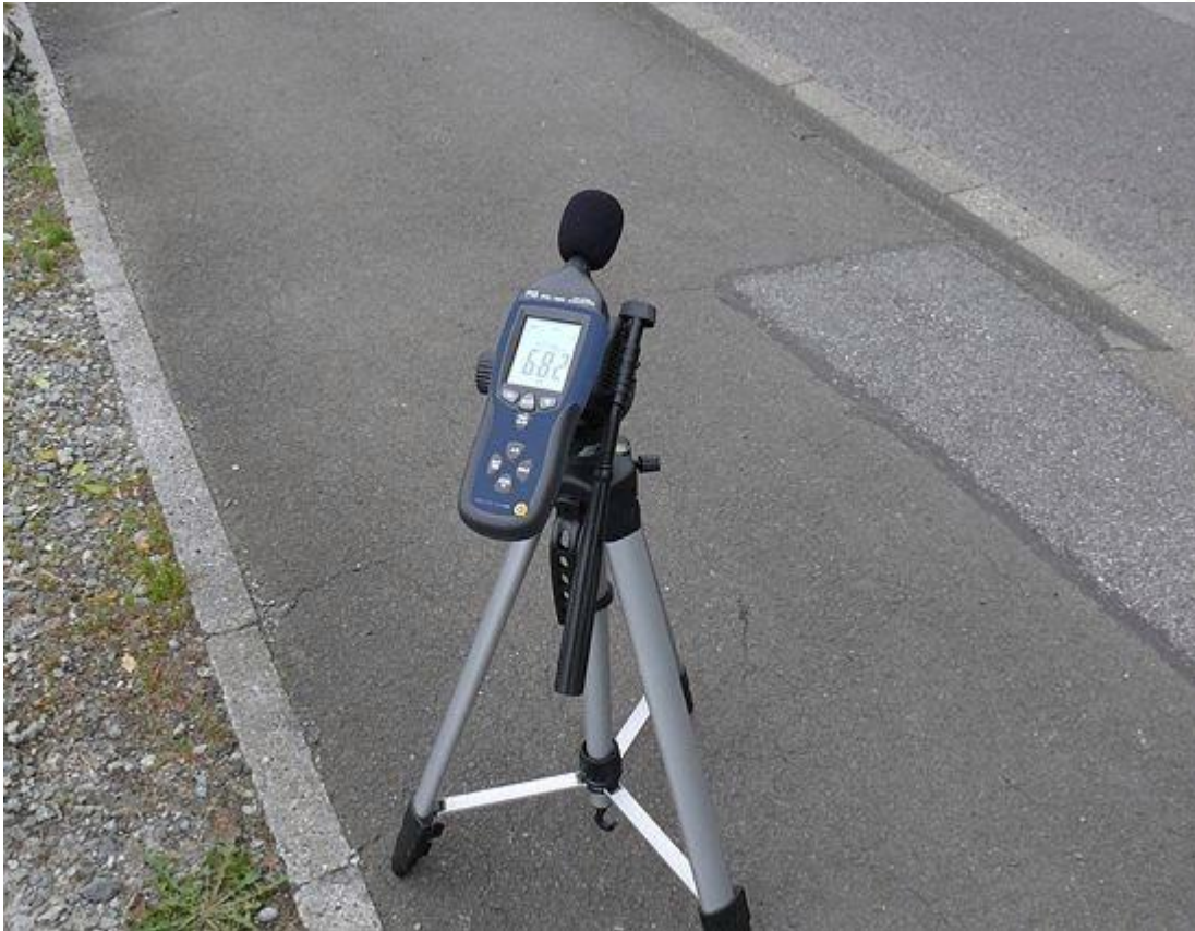
El sonómetro PCE-322 A siendo utilizado para medir el ruido del tráfico (montado sobre un trípode)
