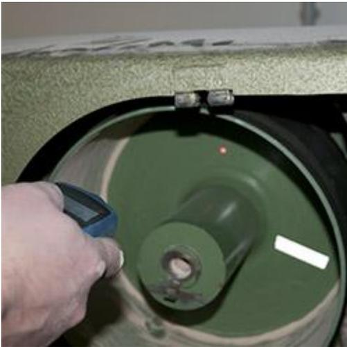
El tacómetro por láser en una medición sin contacto
