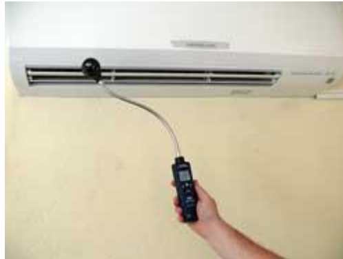
El termoanemómetro de rueda alada midiendo en un aparato de aire acondicionado.
