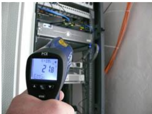
Realizando una medición de un cuadro de control con el termómetro infrarrojo.
