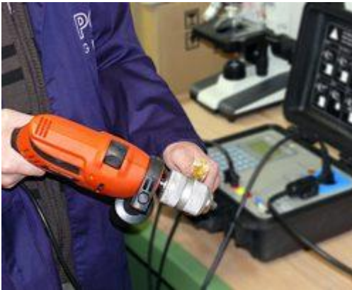
El comprobador VDE Safetytest 1N comprobando una taladradora
