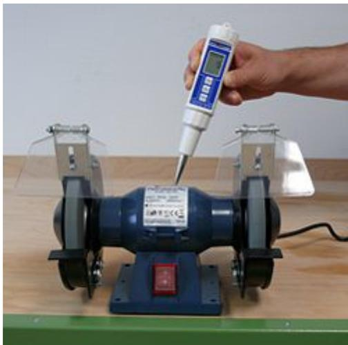
Aquí se ve el vibrómetro comprobando una maquinaria.
