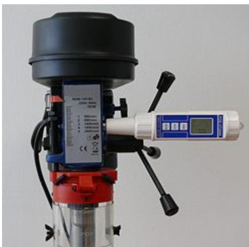
En esta imagen vemos el vibrómetro comprobando una taladradora fija.
