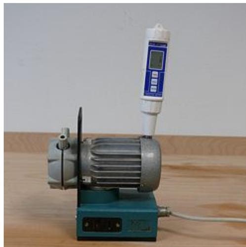
Aquí se puede observar el vibrómetro PCE-VT 2000 analizando un motor.
