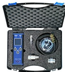
Aquí observa el vibrómetro con todos los accesorios.
