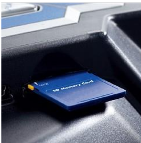
El endoscopio VIS 350 está equipado con una tarjeta de memoria SD para la documentar y archivar imágenes
