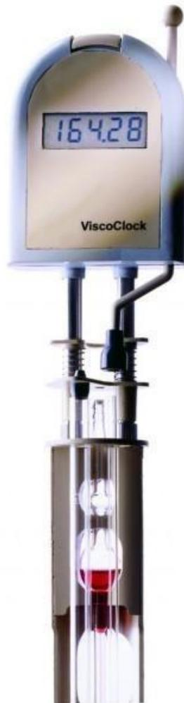
**Observaciones:** Para el atemperado en el termostato son adecuados los siguientes líquidos de atemperado: agua, agua-alcohol (p.e. etanol, metanol), aceite de parafina, aceite de silicona. Se pueden medir fluidos cualificados para el viscosímetro correspondiente utilizado.
