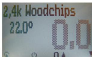
7. Llene el aparato de medición con la muestra uniformemente distribuida para asegurar resultados reproducibles.
