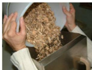
8. Retire el material hasta que el próximo rango menor de peso sea alcanzado. Si sólo falta un poco (por ejemplo, 0,10 kg) para el siguiente nivel superior, se debe llenar hasta esa fase. El peso real se muestra en la báscula.
