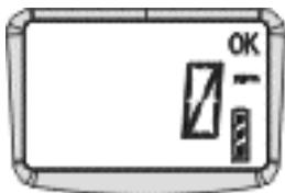
El canal sensor visualiza el valor actual del gas que se está detectando así como las unidades de medición. El símbolo 'OK' parpadeará para indicar que el detector funciona correctamente. Familiarícese con el gas que su instrumento está detectando actualmente. Asegúrese que conoce los procedimientos de salud y seguridad en obra. Para información sobre lecturas máximas y medias temporales ponderadas, vaya a 2.4.
