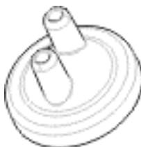
1. Para instalarla, encaje la tapa de recogida de muestras sobre el sensor en la parte frontal del Gasman hasta asegurarla en su sitio.
