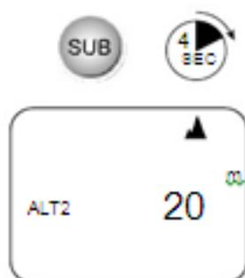
Con el MeteoGuidePro en la pantalla del Altímetro/Altitud Relativa (se muestra icono de la montaña y ALT2), pulse la tecla SUB durante 4 segundos y el valor ALT2 parpadeará. Una pulsación prolongada de la tecla SUB ajusta ALT2 a 0; una pulsación prolongada de la tecla MENU establece el valor de ALT 2 a la altura absoluta actual.
