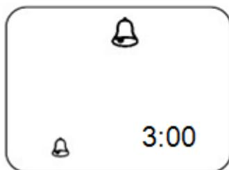
El MeteoGuidePro debe estar en la pantalla Temporizador (el icono de la pantalla o el barco en la parte superior de la pantalla). Pulse la tecla SUB durante 4 segundos, entonces ajuste el periodo de la pre-alarma de la misma manera que el periodo del temporizador explicado más arriba). El tiempo máximo para la pre-alarma es de 99 horas, 59 minutos y 59 segundos y el tiempo mínimo es de 10 segundos. Un ajuste de 0:00 desactiva la pre-alarma.
