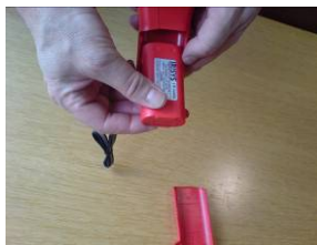
Extracción de la batería
