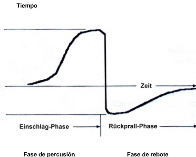
Cuando mida la dureza de un material con un método de prueba estadístico tradicional (cuerpo penetrador...), cualquier modificación de la presión ejercida produce un cambio en el valor de medición. Existirán diferentes curvas de conversión según los diferentes cuerpos penetradores. Por tanto, cuando la dureza Leeb es convertida a otro valor de dureza, deberá facilitarse el cuerpo penetrador utilizado con el valor convertido.
