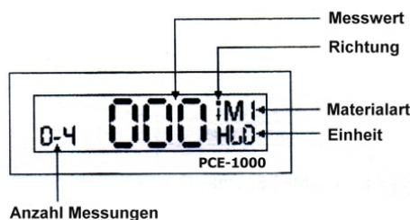
En el PCE 1000 podrá ajustar la dirección de la medición (DIRE), el material (MATE), la unidad (CONV) y la formación del valor medio (AVER). La imagen contigua muestra la configuración del menú.
