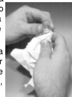
El cristal de la cubeta debe estar totalmente limpio de huellas dactilares, rayas, suciedad, aceite o cualquier sustancia que pueda interferir en la medición.
