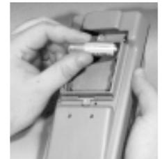
Después vuelva a colocar la tapa protectora y ciérrela con los dos tornillos para que quede bien sujeta.
