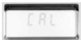
Indica que el modo de calibración está activo. Si la tecla CAL no se presiona de nuevo en 6 segundos, el medidor automáticamente se cambiará a modo de medición.
