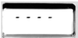
Indica que el medidor está preparado y que se puede realizar ya la calibración o la medición.
