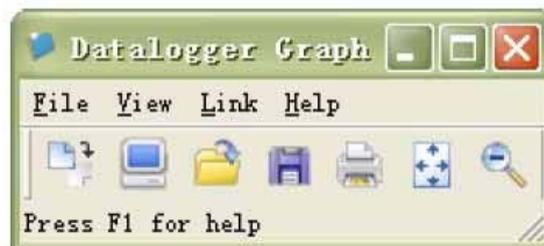
De izquierda a derecha, los iconos simbolizan la descarga de datos, Logger Setup, abrir datos, guardar datos como, imprimir datos, ver todo y zoom. Estos ajustes se pueden realizar también a través de la barra del menú (File, View, etc.).
