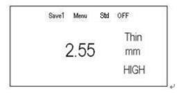
Con las teclas podremos ajustar el espesor de la pantalla una vez que retire la sonda del escalón del bloque de comprobación. Tras este paso posicionaremos la sonda en otro escalón como puede ser el de 20 mm, tras el cual el medidor se pondrá a medir. Tras este paso pulsaremos la tecla tras la cual aparecerá la pantalla:
