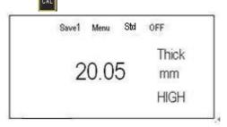
Tras retirar la sonda del bloque ajustamos el espesor con las teclas, paso, pulsaremos la tecla para terminar la calibración en los 2 puntos.
