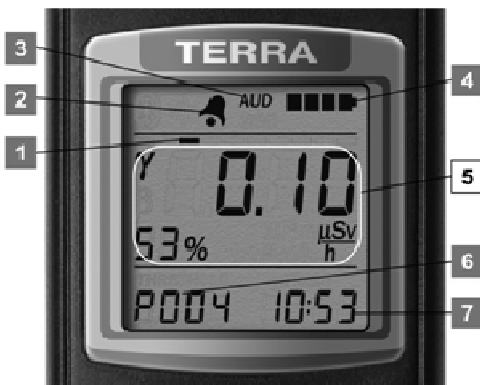
Fig.30 (visualización de los resultados de medición)
