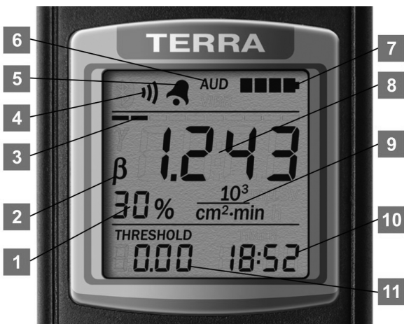
Figura 14 (modo de medición de densidad de flujo de partículas beta de superficie)
