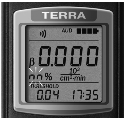
Fig. 17- LCD (reinicio de medición)
