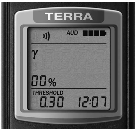
Figura 4 (vista del valor del error estadístico especificado)
