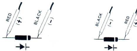
Si se colocan los cables de comprobación de según la imagen 2, se realiza una medición de los diodos hacia atrás. Si el diodo está bien, aparece „OL” en la pantalla. Si el diodo está defectuoso, aparece un „0000” en la pantalla. Cuando se miden diodos se deben utilizar ambos métodos de comprobación.
