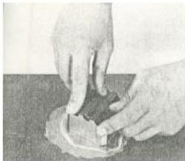
Frote las dos partes mientras presiona firmemente la pieza de trabajo sobre la placa base.
