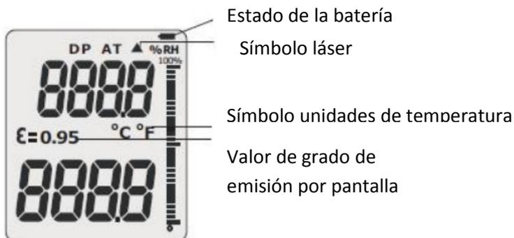
Después del encendido, el aparato detectará la temperatura ambiental, la humedad y la temperatura del punto de rocío, y la mostrará en la parte superior derecha del LC. Pulse la tecla MODO y pase a través de las funciones de temperatura, humedad y temperatura del punto de rocío.
