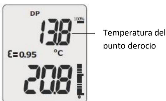
Deje que el aparato enfoque el objeto a medir, retire el detector lentamente, y obtenga la temperatura del objeto, si la temperatura es la que existe entre la temperatura ambiente y temperatura del punto de rocío, la pantalla LCD simulará el valor D con la temperatura ambiente.
