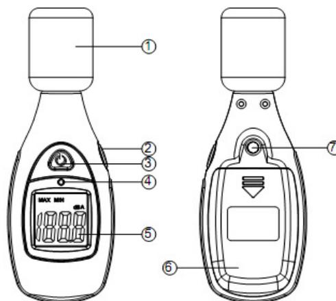
1. Cortaviento y micrófono condensador electreto de 1 / 2 pulgadas
