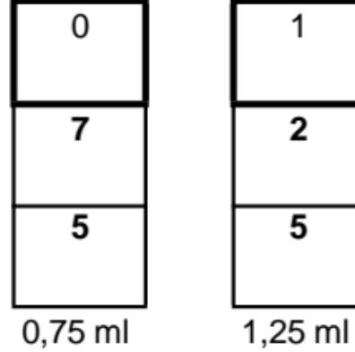
Le volume de la pipette est déterminé grâce à la vis de réglage noire commandant le déplacement du piston. Fig. 1B. L'exactitude maximale, lors de la sélection d'un nouveau
