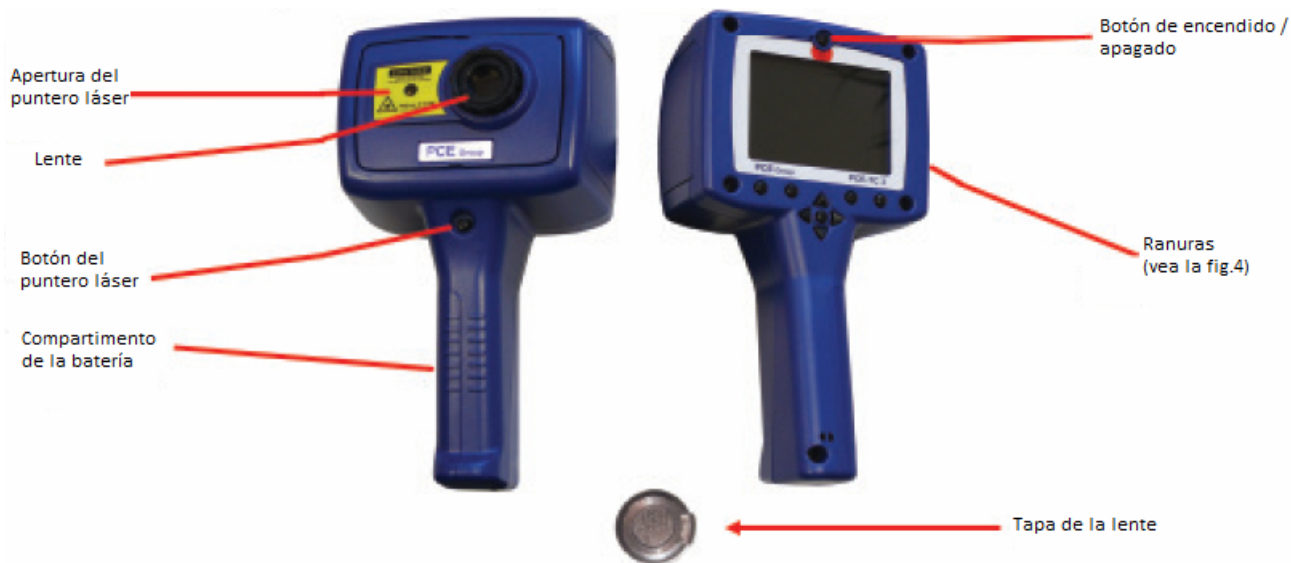
Figura 5: Hardware de la cámara termográfica PCE-TC3
