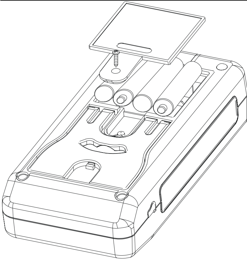
Imagen 5-2. Cambio de batería
