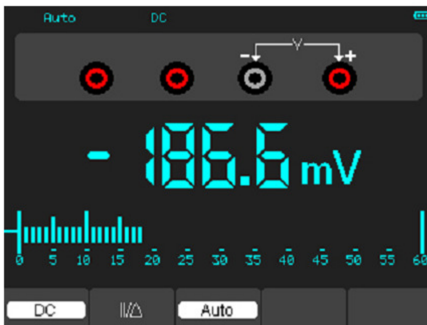
Figura 4-6 Medición de tensión en DC
