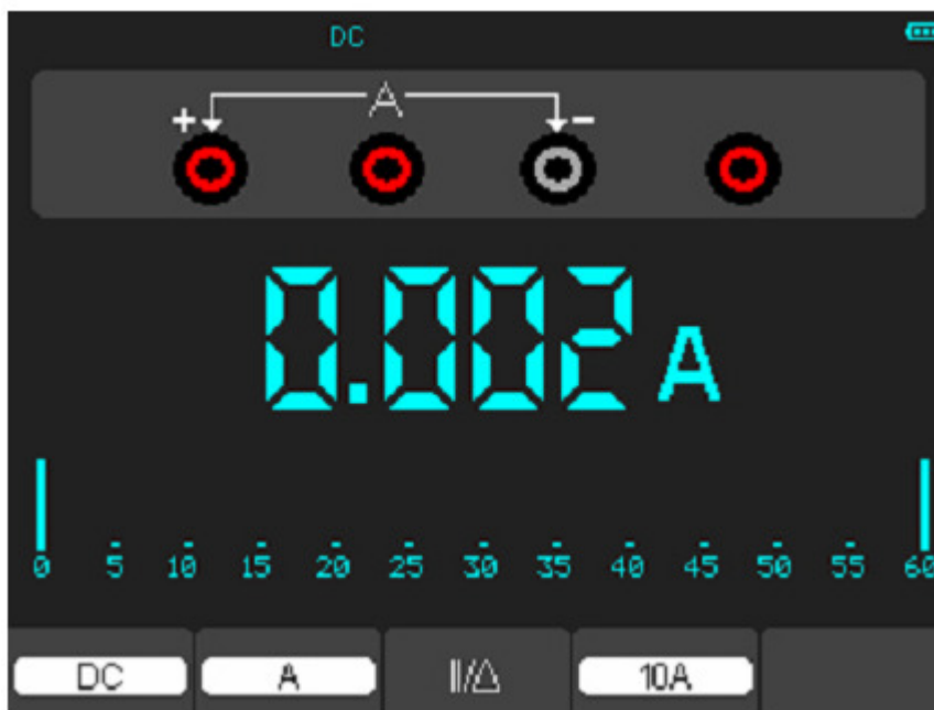
Figura 4-9 Medición de corriente DC para 10A
