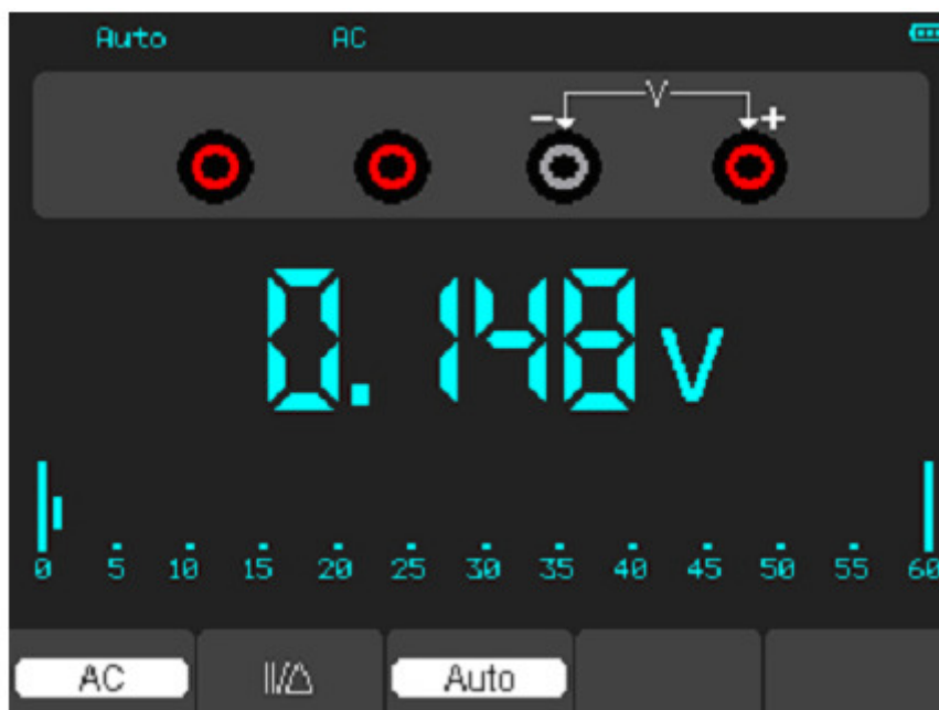
Figura 4-7 Medición de tensión en AC
