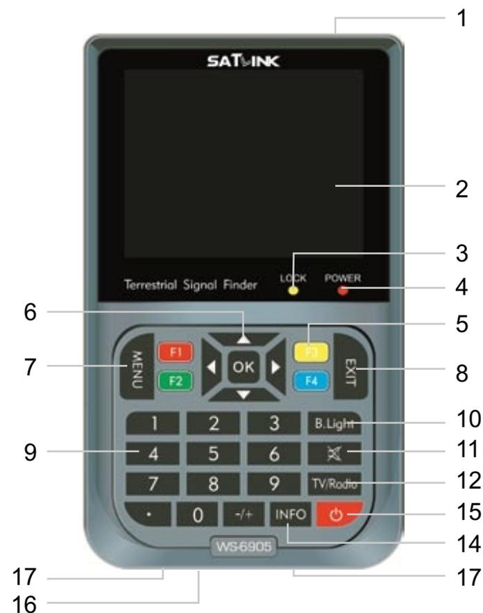
[1] **ENTRADA ANTENA:** conexión de entrada directa de la señal de la antena terrestre mediante cable coaxial.
