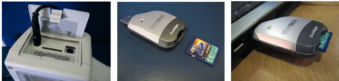
Bild 4 SD-Karte entnehmen und in den Leser einlegen
