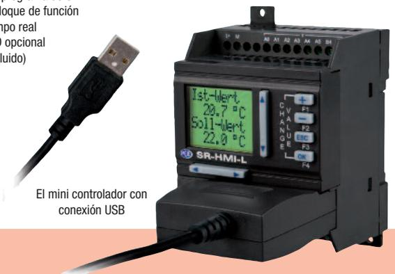
El mini controlador con conexión USB
