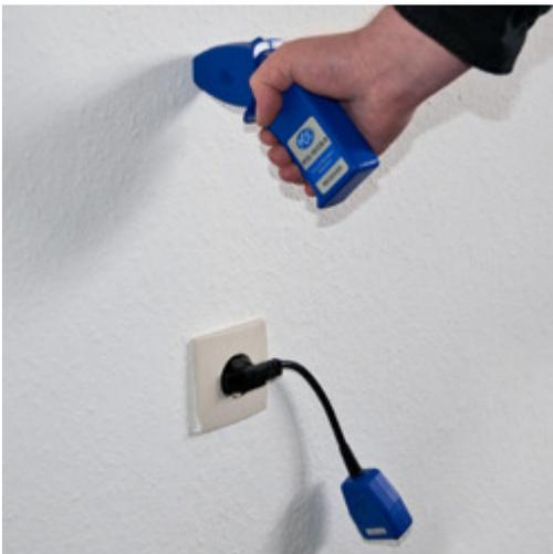
Conecte el transmisor del detector de cable al enchufe en la pared y siga con el receptor la línea en la pared
